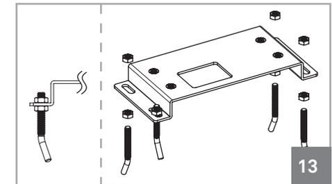
03 • Fije los tornillos a la placa con las tuercas, como se muestra en la Figura 13.
