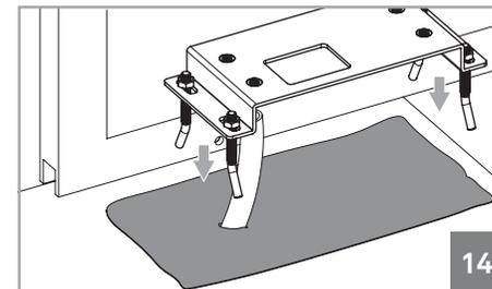
04 • Inserte la placa con tornillos en el hormigón aún estando fresco y nivelar horizontalmente con un nivel. También se alinean en paralelo a la puerta, manteniendo una distancia de 60 mm entre ellos, como se ve en la foto 16.
