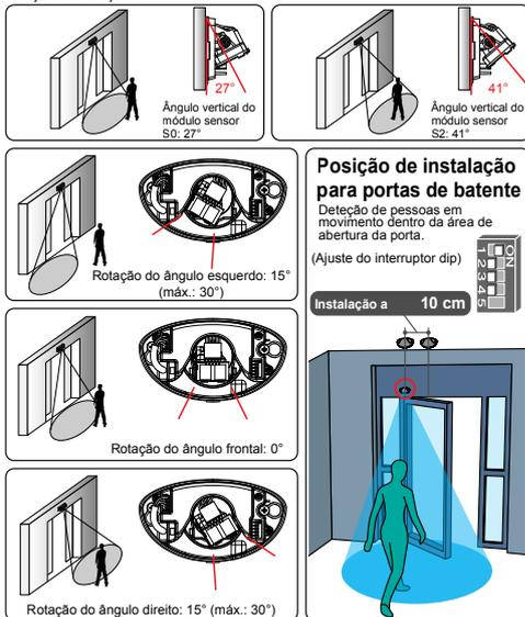
**Posição de instalação para portas de batente**
