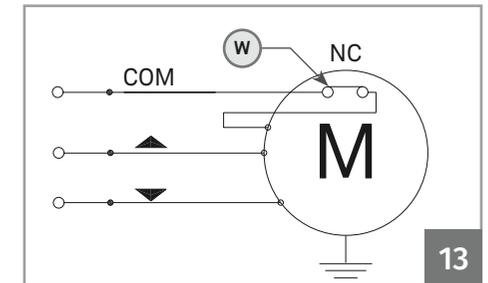
**04** • Für Mikro Versionen, verbinden Sie das Kabel des Mikroschalters (W) in Reihe mit der dem Kabel der Stromversorgung (gemeinsame) des Getriebemotors.
