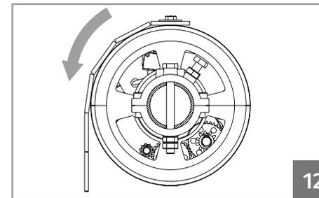
**03** • Die Abwärtslauf der Rollladen ist im Einklang mit der Abwärtslauf der Sicherheitsbremse. Platzieren Sie den Getriebemotor, wie in bild gezeigt.
