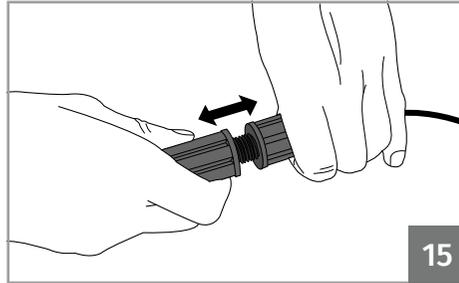
Um den Motor zu entriegeln, lösen Sie einfach das Entriegelungsstück am Ende des Stahlkabels, indem Sie es nach links drehen. Um den Motor wieder zu verriegeln, ziehen Sie das gleiche Teil fest.
