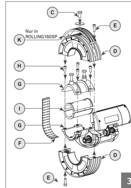
04 • Entfernen Sie die zwei halb Krone (D) Lösen der zwei Schrauben M8 (E), wie in Bild 3 dargestellt.
