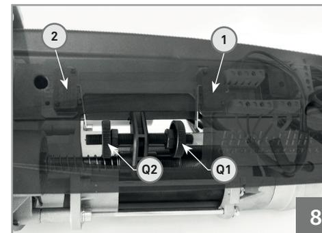
19 • Nach der Installation der mechanischen Teile und die elektrischen Anschlüsse, fahren Sie fort mit der Regulierung der Endpositionen, wie in der Bild 8 dargestellt.
