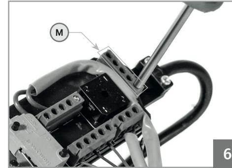
17 • Schließen Sie die Stromkabel an die Karte durch das Terminal (M) unter Beachtung der richtigen Richtung (Bild 6). Ziehen Sie die Stromkabel an der Klemmleiste mit den vier Schrauben.
