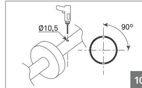
**01** • Bohren Sie am Rohr ein  $\varnothing 10$  Loch, senkrecht zur Achse.
