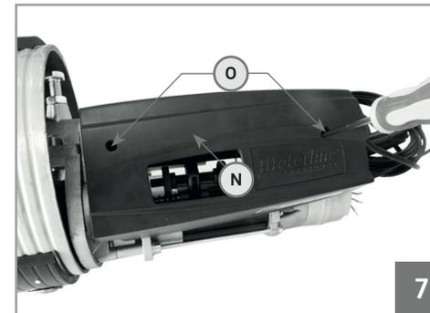
18 • Schliessen Sie den Kunststoff Deckel an der Platine (N) und ziehen Sie es mit zwei Schrauben (O), überprüfen Sie die korrekte Kabelführung (Bild 7).
