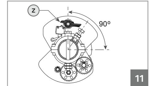
**02** • Nach dem Zusammenbau der beiden Elemente des Getriebes (G), stellen Sie sicher, dass der Auslöser (Z) in der höchsten Position der senkrecht zur Rollladen Achse.
